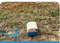
Sismique passive Enregistrement de la sismicité naturelle du sous-sol à partir de géophones (capteurs).
